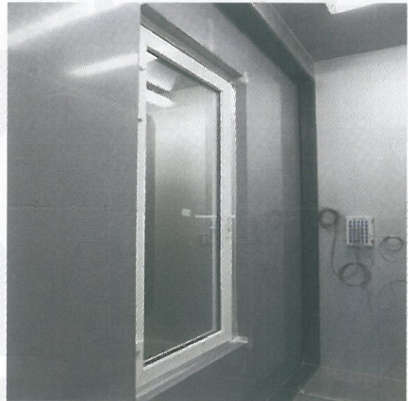
<사진 2> 열관류율 저온측 시험체 모습
